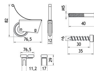
Комплект роликов усиленных на 1 дверь для асимметричной ручки
