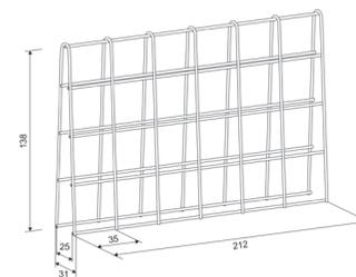
**Делитель сетчатой полки**
