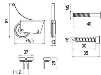
Комплект роликов усиленных на 1 дверь для симметричной ручки
