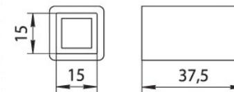
**Соединитель стойки сетчатого каркаса**
