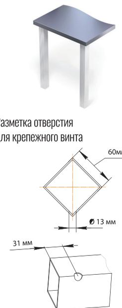
Разметка отверстия для крепежного винта
