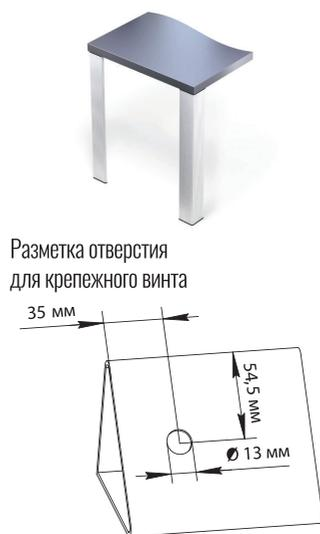
Разметка отверстия для крепежного винта
