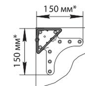
Кронштейн крепления к столу для треугольной опоры
