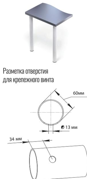
Разметка отверстия для крепежного винта
