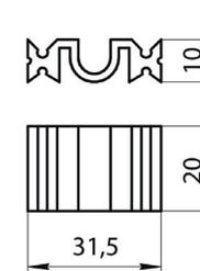
**Клипса делителя сетчатой полки**
